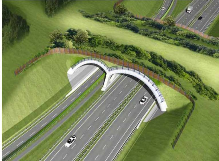
Abb. 3: Computersimulationsplanung für eine Wildbrücke über der B 101 nahe Thyrow in Brandenburg
